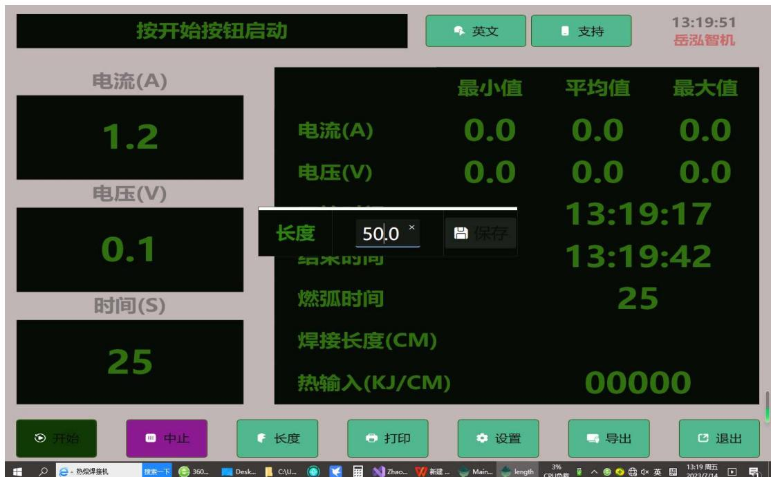
图 4 焊接长度输入窗体图
